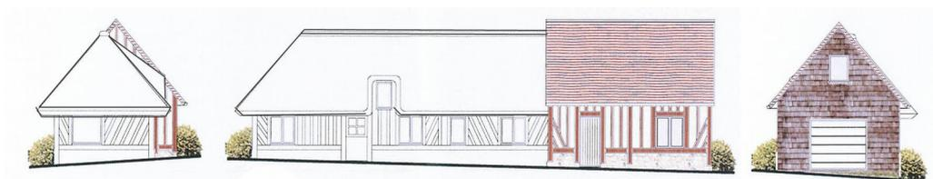
À Bouquetot, la modification de l'entre-colombage a pour objet d'apporter quelque lumière grâce à la pose de fenêtres au niveau de l'entrecolombage. Cela ne modifie pas la structure du colombage et est donc préférable à l'option de couper des colombes.
